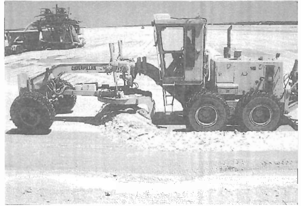
天日塩田で析出した塩の床を掻き起こして集め、塩の畝を作る作業中のグレーダー
